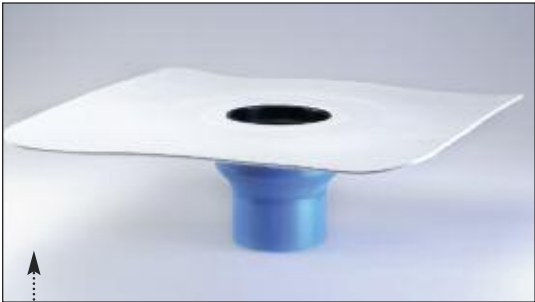
Alpha-Gully Unterteil in senkrechter Ausführung mit angebrachter Anschlussmanschette. Die sogenannte Einsteckmuffe ist eine eingebrachte Lippendichtung im Einlaufbereich (rechts).
