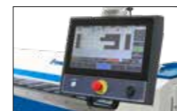
Bedienerfreundliche 15,6" Touchscreen NC-Steuerung an ergonomischen Schwenkarm
