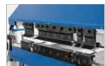
Alle drei Werkzeuge segmentiert und mit Schnellwechselsystem
